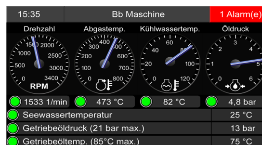
Seite 1: Werte und Statusanzeigen eines Motors
