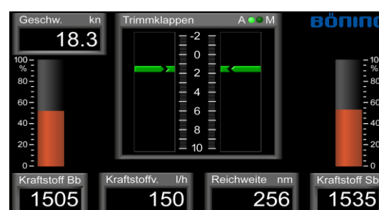
Seite 2: Trimmklappenwinkel, GPS-Geschwindigkeit, Reichweite, Kraftstoffverbrauch, Tankinhalte
