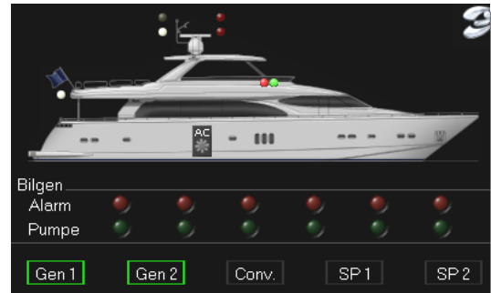
Seite 1: Positionslaternen, Bilgen und Pumpen, Status der Motorraumlüfter, Status der Energieversorgung
